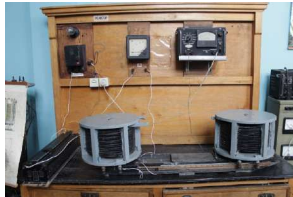
Трансформатор для регулювання напруги
