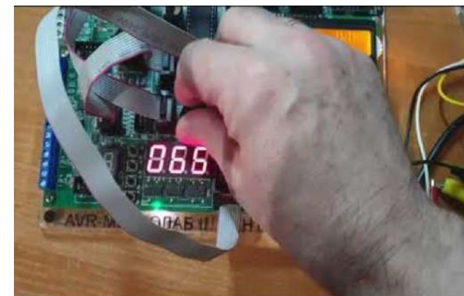
Приклад дослідження роботи SPI інтерфейсу стенду AVR-МІКРОЛАБ з використанням цифрового осцилографа в якості логічного аналізатора
